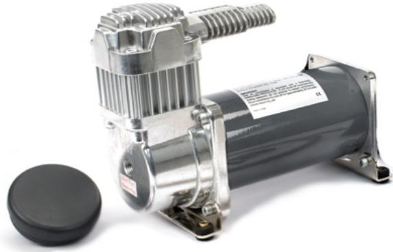
BAMBI工业级 (IG) 压缩机是专门为填充储气罐而设计的，其头部组件包括新开发的、正在申请专利的创新头部设计，以更好地散热。所有IG压缩机均通过CE规范认证，并具有卓越的元件密封性能。此外，所有IG压缩机都配备了一个单独的不锈钢编织PTFE内衬引导软管和止回阀组件，可保护压缩机免受高电流重启的影响。
